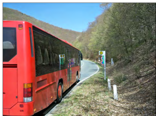
Bushaltestelle an einer anbau-freien Außerortsstraße ohne befestigte Aufstellfläche
