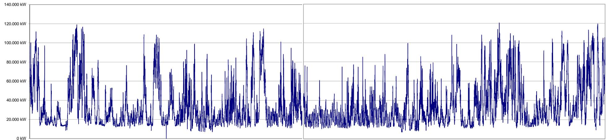
**Bemerkung:** Summe aller Netzeinspeisungen in Mittelspannung (Rückspeisungen ins HSP-Netz möglich)
