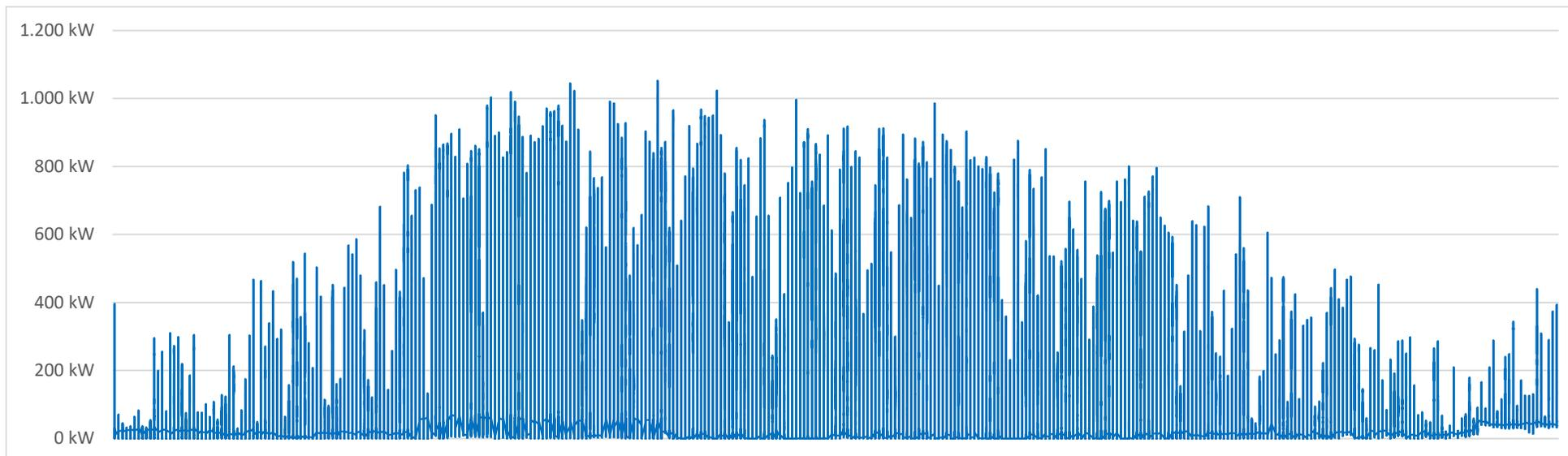
**Bemerkung:** Summe aller Netzeinspeisungen in Umspannung Mittelspannung zu Niederspannung (Rückspeisungen ins MSP-Netz möglich)
