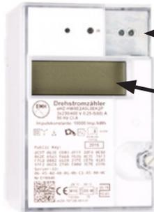
**Optischer Sensor:** Der Sensor erkennt Lichtsignale z.B. von einer handelsüblichen Taschenlampe. Dazu leuchten Sie den Sensor mit der gewünschten Anzahl der Signale an.
